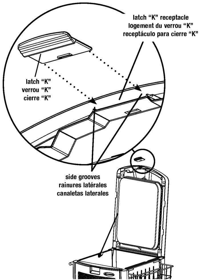
19. Laissez le couvercle relevé et insérez le verrou "K" dans le logement qui lui est destiné. Les bords latéraux du verrou "K" devraient se loger dans les rainures latérales du couvercle comme illustré. Pressez afin que la pièce s'encastre d'un bruit sec.
