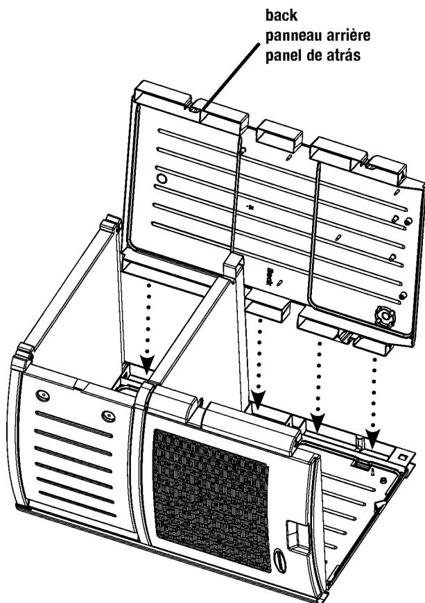
4. Placez les languettes du panneau arrière dans les logements correspondants du panneau latéral droit "R". Pressez afin que les pièces s'imbriquent d'un bruit sec.
