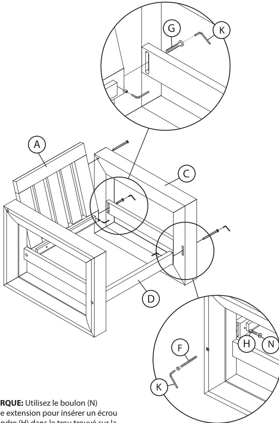
**REMARQUE:** Utilisez le boulon (N) comme extension pour insérer un écrou de cylindre (H) dans le trou trouvé sur la traverse (D). Visser le boulon dans la partie supérieure de l'écrou. Une fois verrouillé (F) est fixé à travers le cadre et dans écrou de canon (H), retirez le boulon (N) de écrou de canon (H).
