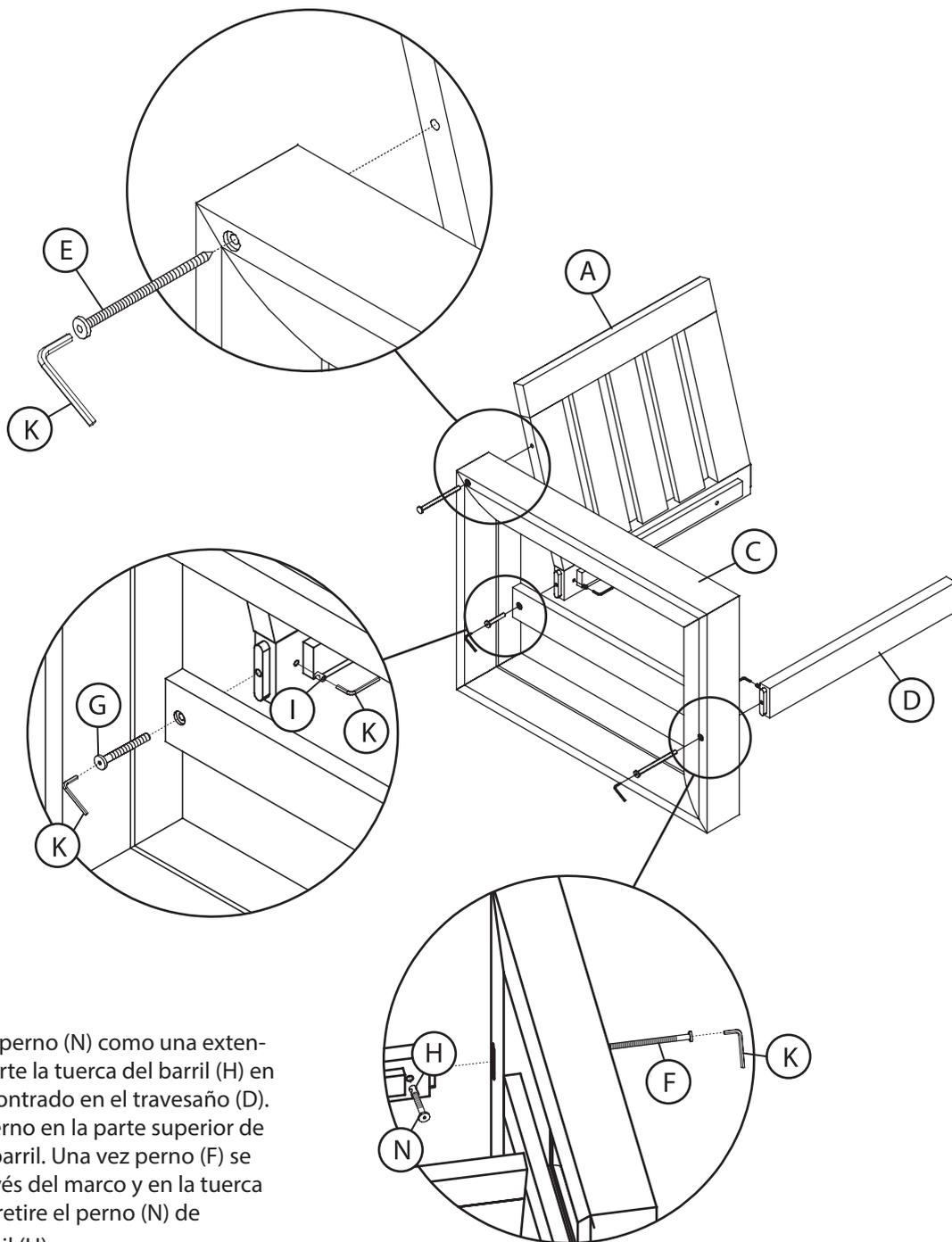
**NOTA:** Use el perno (N) como una extensión para inserte la tuerca del barril (H) en el orificio encontrado en el travesaño (D). Atornille el perno en la parte superior de la tuerca del barril. Una vez perno (F) se asegura a través del marco y en la tuerca del barril (H), retire el perno (N) de tuerca de barril (H).
