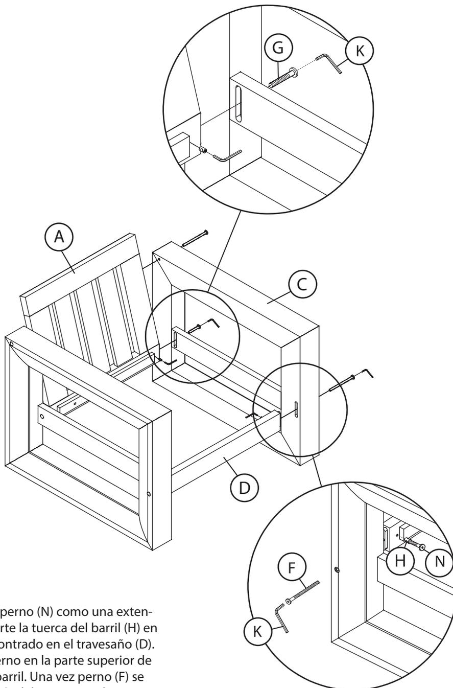
**NOTA:** Use el perno (N) como una extensión para inserte la tuerca del barril (H) en el orificio encontrado en el travesaño (D). Atornille el perno en la parte superior de la tuerca del barril. Una vez perno (F) se asegura a través del marco y en la tuerca del barril (H), retire el perno (N) de tuerca de barril (H).
