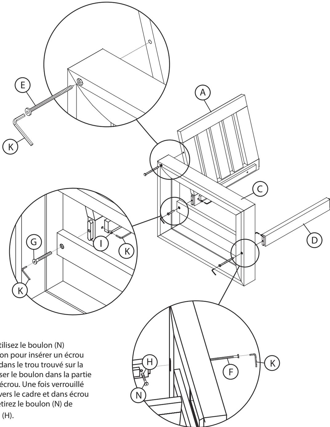
**REMARQUE:** Utilisez le boulon (N) comme extension pour insérer un écrou de cylindre (H) dans le trou trouvé sur la traverse (D). Visser le boulon dans la partie supérieure de l'écrou. Une fois verrouillé (F) est fixé à travers le cadre et dans écrou de canon (H), retirez le boulon (N) de écrou de canon (H).
