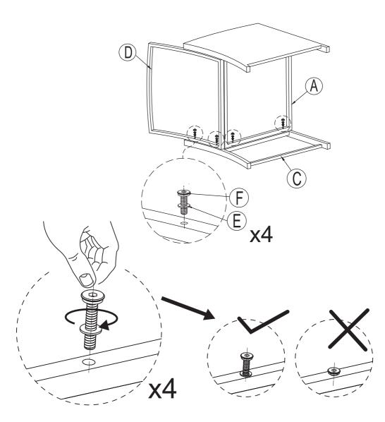
NOTE: DO NOT TIGHTEN THE SCREWS COMPLETELY.
