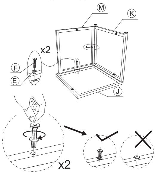
NOTE: DO NOT TIGHTEN THE SCREWS COMPLETELY.
