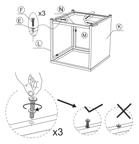
NOTE: DO NOT TIGHTEN THE SCREWS COMPLETELY.
