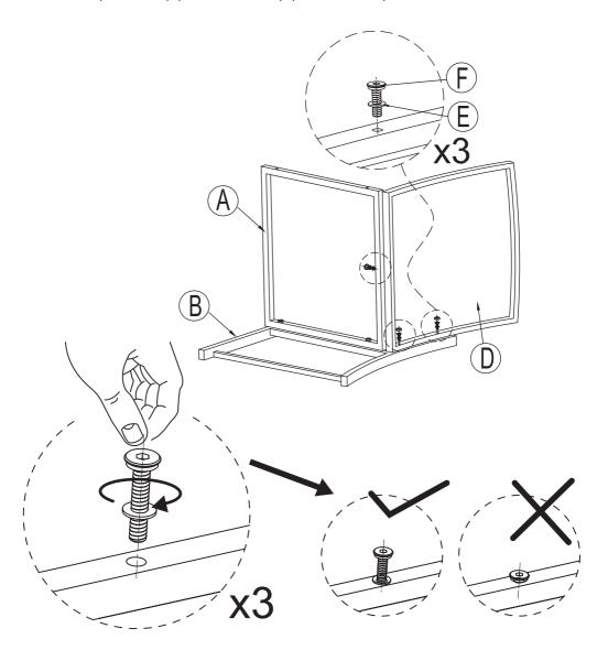
NOTE: DO NOT TIGHTEN THE SCREWS COMPLETELY.
