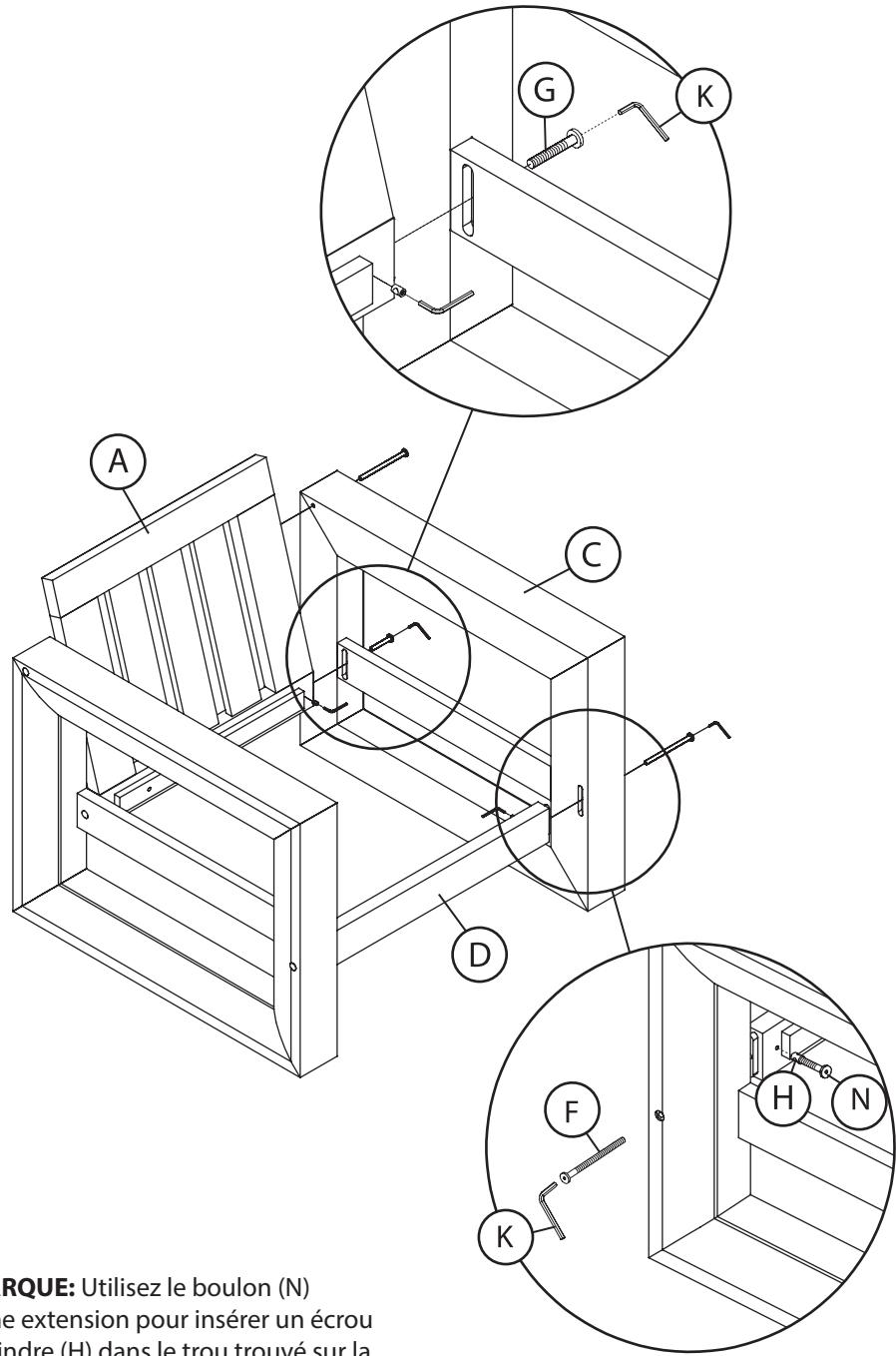
**REMARQUE:** Utilisez le boulon (N) comme extension pour insérer un écrou de cylindre (H) dans le trou trouvé sur la traverse (D). Visser le boulon dans la partie supérieure de l'écrou. Une fois verrouillé (F) est fixé à travers le cadre et dans écrou de canon (H), retirez le boulon (N) de l'écrou de canon (H).
