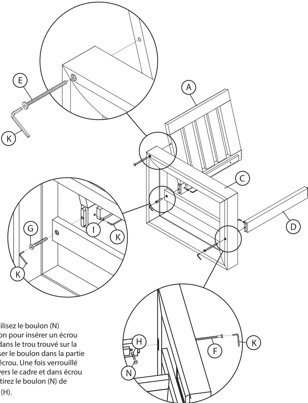
**REMARQUE:** Utilisez le boulon (N) comme extension pour insérer un écrou de cylindre (H) dans le trou trouvé sur la traverse (D). Visser le boulon dans la partie supérieure de l'écrou. Une fois verrouillé (F) est fixé à travers le cadre et dans écrou de canon (H), retirez le boulon (N) de l'écrou de canon (H).
