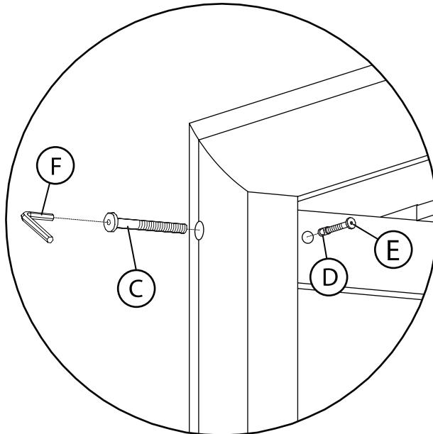
**NOTA:** Use el perno (E) como una extensión para inserte la tuerca del barril (D) en el orificio encontrado en la base otomana (A). Atornille el perno en la parte superior de la tuerca del barril. Una vez perno (C) está asegurado a través del marco y en la tuerca cilíndrica (D), retire el perno (G) de Tuerca de barril (D).
