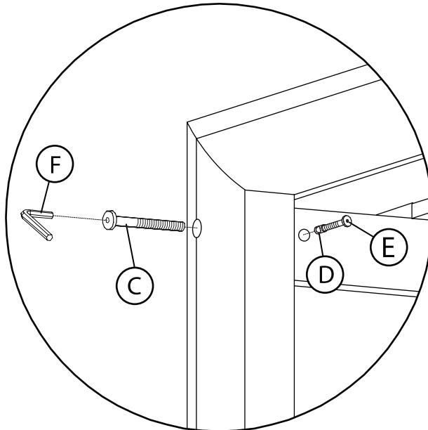
**REMARQUE:** Utilisez le boulon (E) comme extension pour insérer un écrou de canon (D) dans le trou trouvé sur la base du pouf (A). Visser le boulon dans la partie supérieure de l'écrou. Une fois verrouillé (C) est fixé à travers le cadre et dans écrou de canon (D), retirez le boulon (G) de écrou de canon (D).
