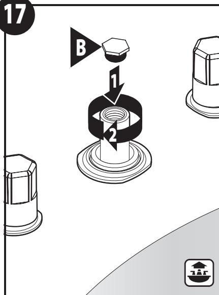
Install Test Plug (**B**).
