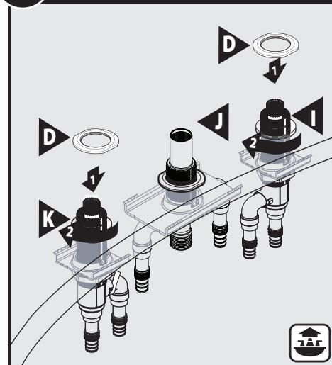
Top thread 1/8" (3mm) above deck when complete. Enrosque hasta dejar 1/8" (3 mm) de distancia con respecto a la cubierta al completar el trabajo. Les rainures du corps de la soupape devraient être à 3 mm (1/8 po) au-dessus de la plateforme lorsque terminé.
