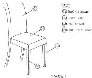
DO NOT TIGHTEN ALL THE SCREWS UNTIL THE CHAIR HAS BEEN PUT ON A FLAT SURFACE TO ADJUST & LEVEL ALL THE LEGS SO THAN THEY DO NOT WOBBLE ONCE ADJUSTER THEN TIGHTEN ALL THE SCREWS.
