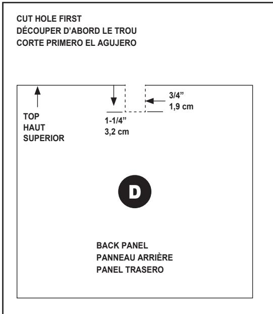
**CUT HOLE AT TOP OF BACK PANEL BEFORE NAILING ON!**
