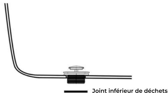
5. Prendre la tête de drain et y attacher la passoire par en-dessous de la baignoire. Serrer autant que possible.
