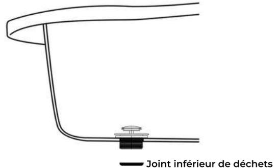
5. Prendre la tête et dévisser le bouchon droit pour connecter à l'anti-débordement. Il y a un joint qu'il vous faudra retirer pour attacher le drain. Le garder de côté pour l'instant.
