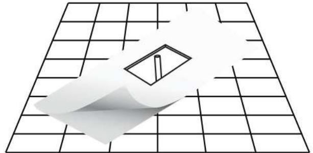
3. Déterminer l'emplacement de l'évacuation d'eau sur le sol en mesurant le drain et le trou d'évacuation sous la baignoire. Nettoyer la zone et le trou d'évacuation avant l'installation. Assurez-vous que la zone soit sèche et sans résidus.
