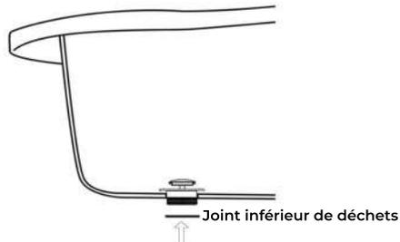
5. Prendre la tête de drain et dévisser le capuchon côté droit pour l'assembler à l'anti-débordement. Il y a un joint qu'il vous faudra retirer pour attacher le drain. Le garder de côté pour l'instant.
