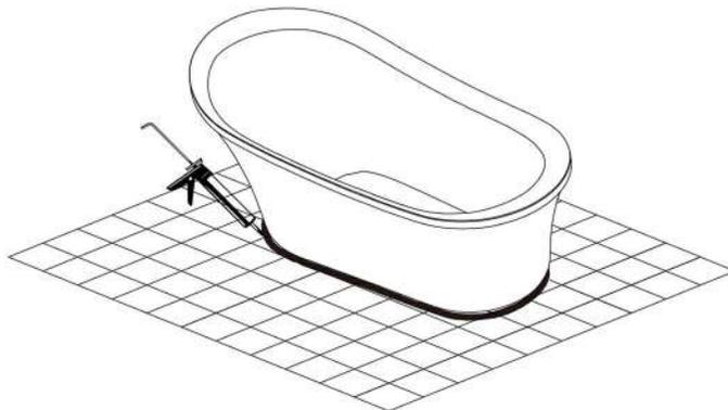
13. Maintenant que la baignoire est en place, retirer l'excédent de silicone et d'isolant.
