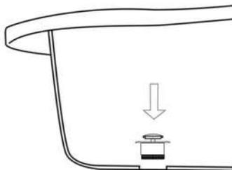
4. Prendre le joint retiré au préalable et le remettre dans la passoire par en-dessous de la baignoire.
