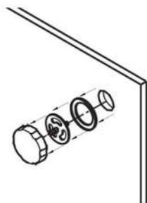
2. Veuillez retirer le gros joint en caoutchouc ainsi que le drain anti-débordement de l'arrière de la baignoire.
