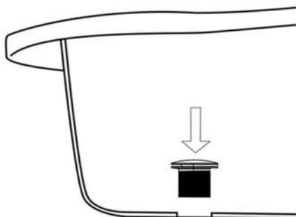
4. Prendre le joint inférieur retiré au préalable et le rattacher à la passoire par en dessous de la baignoire.
