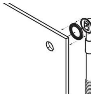
3. Prendre la plaque anti-débordement et la placer sur le trou anti-débordement. Prendre la visse de sécurité et la visser pour fixer. Prendre le cache anti-débordement et le visser sur la visse de sécurité.
