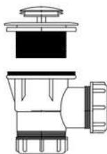
2. Retirer le joint en caoutchouc le plus gros. NE PAS RETIRER LE PETIT JOINT DU BAS.
