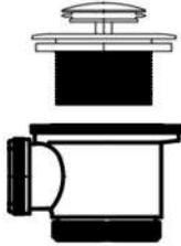
2. Retirer le joint en caoutchouc le plus gros. NE PAS RETIRER LE PETIT JOINT DU BAS.
