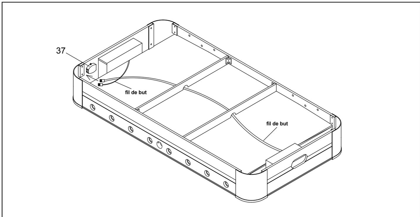
Serrer à la main TOUS les boulons pendant l'assemblage et effectuer le serrage final une fois l'assemblage en place.
